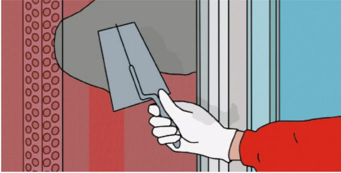
5. Далее в этот профиль заводится армирующий слой THERMOMAX-120 с сеткой от армирующего уголка. Если сетки от армирующего уголка и профиля примыкания недостаточно для перехлеста, необходимо вырезать полосу армирующей сетки для обеспечения полного армирования откосов и их угловых частей.
