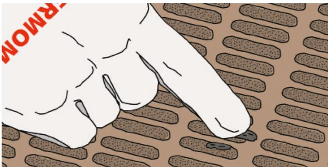
1. Необходимо проверить поверхность теплоизоляционных плит на предмет наличия инородных включений и удалить при наличии.
