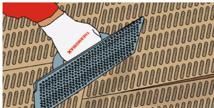
17. Смонтированные плиты должны находиться в одной плоскости. В случае обнаружения неровностей не более 2–4 мм на поверхности их следует отшлифовать специальной теркой. Выравнивание неровностей за счет увеличения толщины базового армировочного слоя не допускается.
