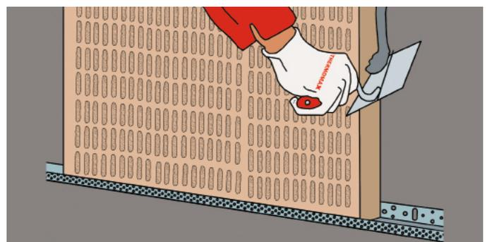
8. Излишки клея после приклеивания плит следует удалить при помощи шпателя. Оставлять клеевой состав на торцах плит не допускается.
