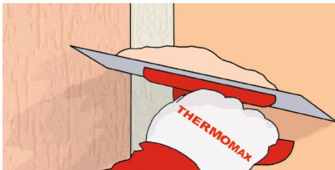
**8.** После перерыва малярная клейкая лента наклеивается на край ранее нанесенной штукатурки и снимается после нанесения стыковочной полосы декоративной штукатурки..
