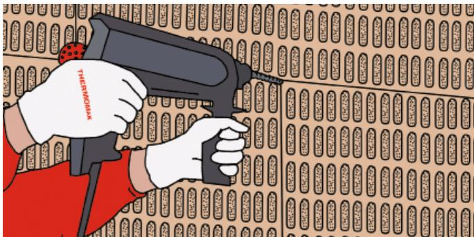
2. Для просверливания отверстий используется дрель со сверлом необходимой длиной, учитывающей толщину плиты утеплителя и глубину анкеровки. Глубина засверливания должна быть больше глубины анкеровки на 10-15 мм.
