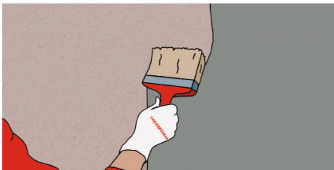
1. Окончательная отделка фасада возможна по истечении не менее 3 суток после нанесения базового штукатурного слоя. Для достижения хорошей адгезии поверхность армирующего слоя грунтуется адгезионной грунтовкой Thermomax-301 при помощи кисти и валика.
